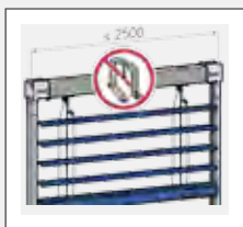
Construction de stores autoporteuse
